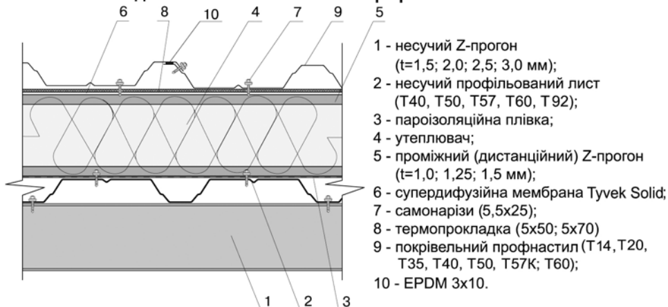
Рис. 3.1. Повздовжній стик листів металопрофілю
